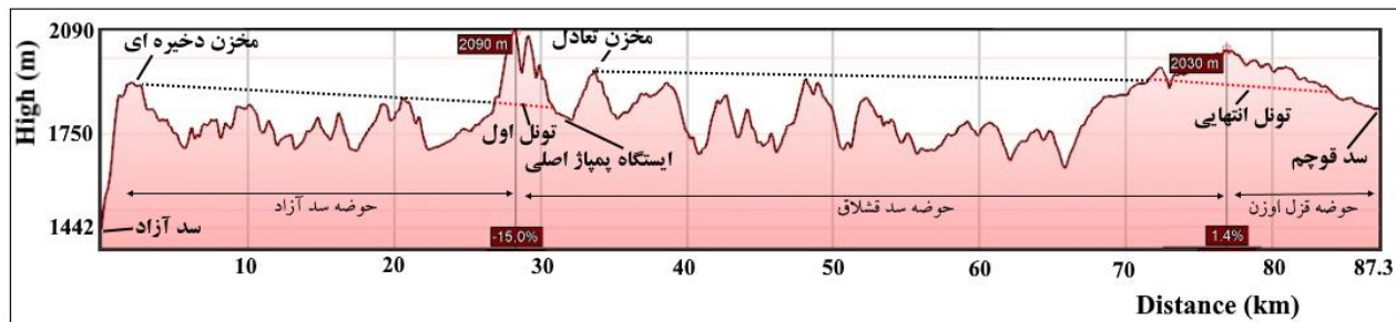
نمودار (۴-۱۵) پروفیل طولی مسیر سامانه انتقال آب از سد آزاد به دشت‌های قروه-دهگلان
